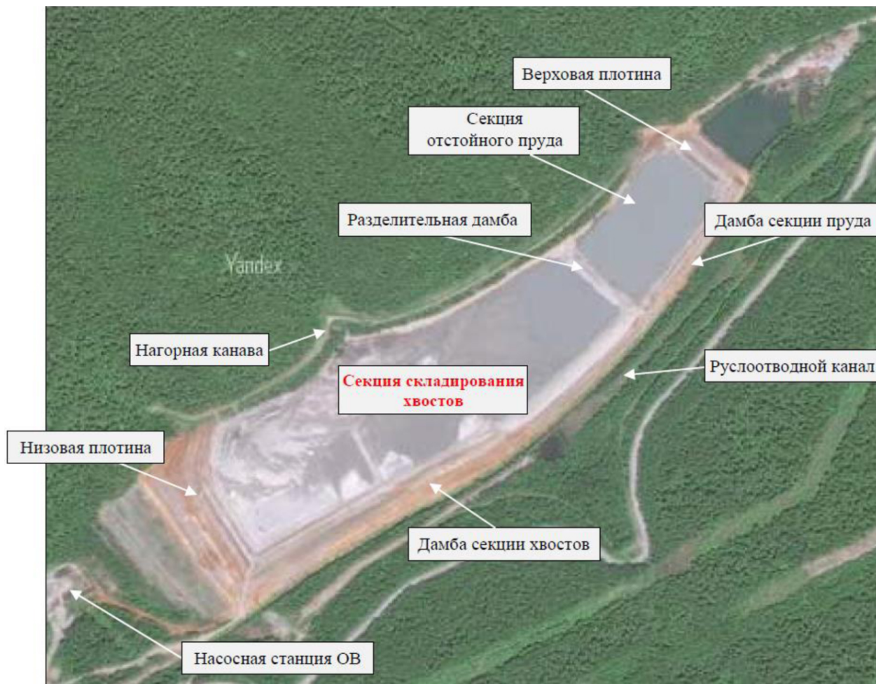
Рисунок 5.5.1 – Ситуационный план действующего хвостохранилища
